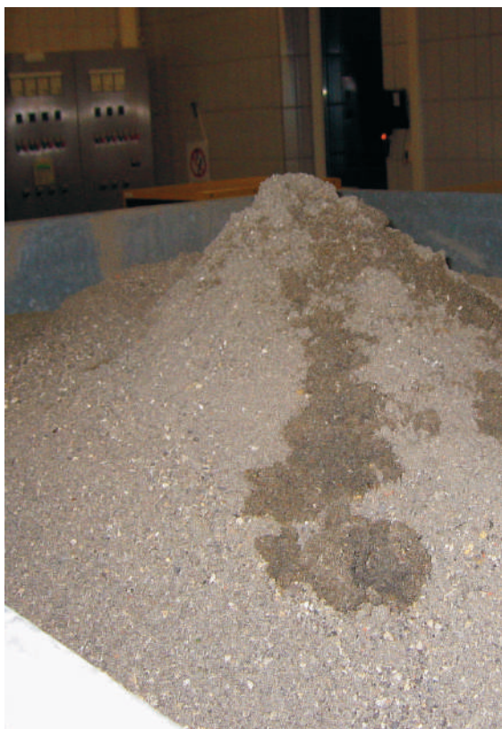
Produto final - Nível de eliminação > 90% - Perda de Peso por Ignição (PPI) < 5%
