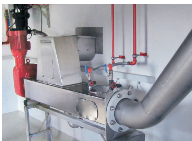
Prensa Lavadora de parafuso Meva - Compacta e fácil de operar
